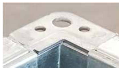
Nepravilna montaža prirubnice ✗
